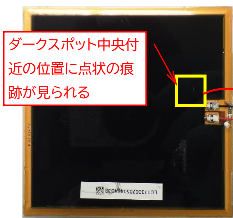
<図 5.3.2>裏面の打痕 (ダークスポットの位置の裏面の 黒いフィルム上に打痕がある)
