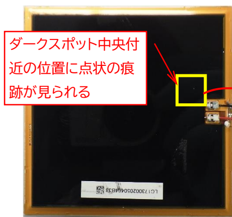
<図 5.3.2>裏面の打痕 (ダークスポットの位置の裏面の 黒いフィルム上に打痕がある)
