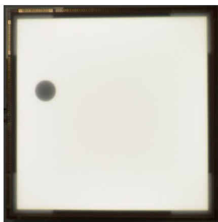
<図 5.3.1> 発光面に生じたダークスポットの例(ダークスポットの直径は約 8 mm)
