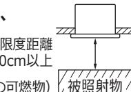
!**発煙や異臭、異音、異常な発熱など、異常を感じた場合、器具が破損した場合は、すぐに電源を切り、器具の電源が接続されているブレーカーを落とし、販売店・工事店に連絡する。**
